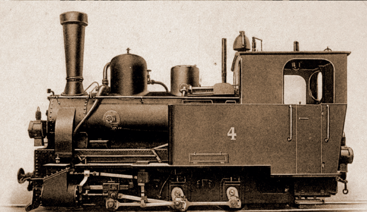
Schmalspurige C-Zweizylinder-Nassdampf-Kleinbahn-Tenderlokomotive der Kleinbahn Lingen-Berge-Quakenbrück gebaut von HANOMAG Hannover-Linden.
